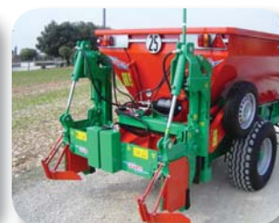
Doble subsolador con o sin alimentación
