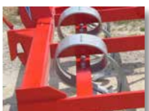
Bastiment reforçat amb tub estructural
