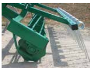
Rodet Ø400 montat amb suport i rodament
