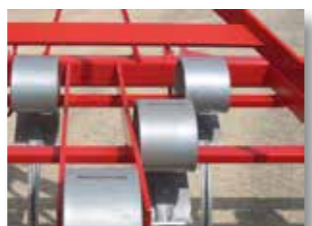
Anclatge dels braços sobre barra massissa
