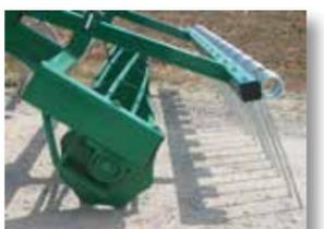
Rulo Ø400 montado en soporte y rodamiento
