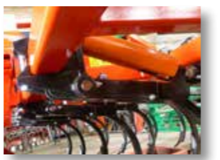
Xassís reforçat de tub estructural
