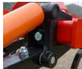
Sistema de fixació del braç al xassís
