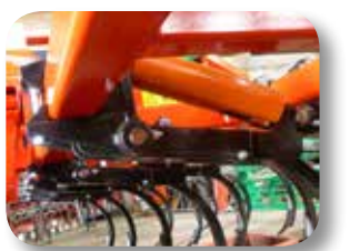
Bastidor reforçat amb tub estructural
