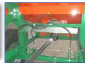
Transmissió interior i fre hidràulic de servei
