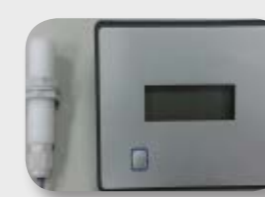
Comptador de voltes pels discs
