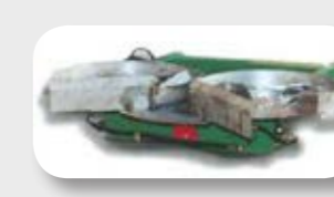
Localitzador d'adob pel sistema de doble disc
