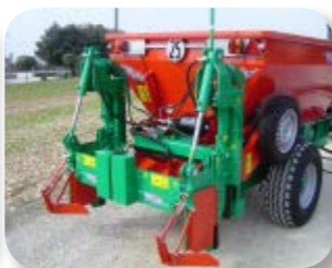
Doble subsolador amb o sense alimentació
