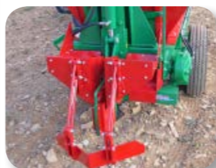
Un subsolador regulable en alçada
