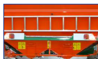
Échelle d'accès à la trémie
