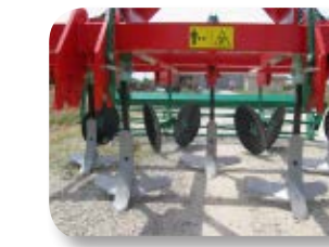
Bastiment reforçat amb tub estructural de 100x100
