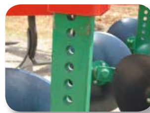
Sistema de regulació de l'alçada dels discs
