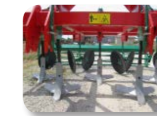
Bastidor reforzado con tubo estructural de 100x100
