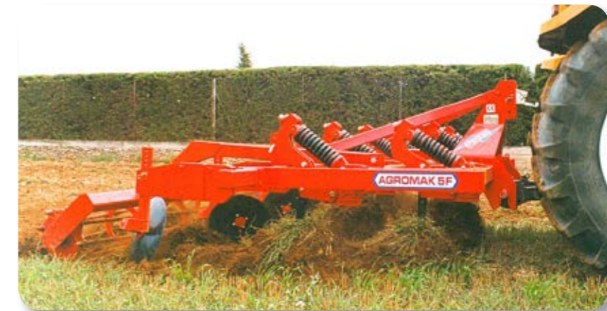
Dent protégé par double ressort « NO-STOP » pour terrains avec accrochages
