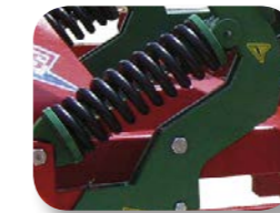
Dent protégé par double ressort « NO-STOP » pour terrains avec accrochages
