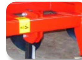
Dents protégé par un fusible pour terrains sans obstacles
