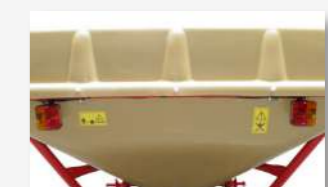
Instalación de luces de señalización
