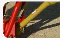
Accionamiento mecánico mediante PTO a 540 rpm
