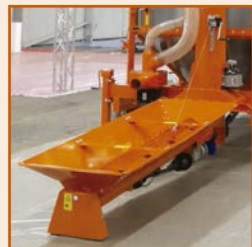
Loading hopper 800 × 2400 mm for AGD series Tolva de carga 800×2400 mm para serie AGD
