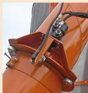
Hydraulic motor for swiveling cap driving Motor hidráulico para el movimiento de la boca de descarga
