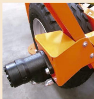
Hydraulic motor for recycling gate driving Motor hidráulico compuerta de recirculación
