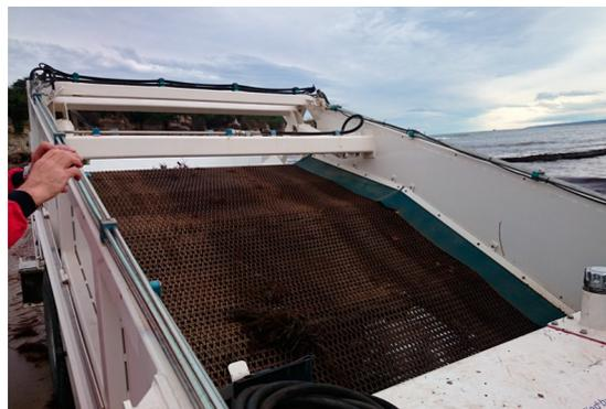
Malla Triangular entrelazada de acero al carbón de alta resistencia y de 23mm de luz.
