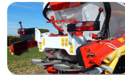
Double système de distribution disques - tarières
