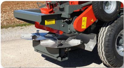
Deux disques centrifuges
