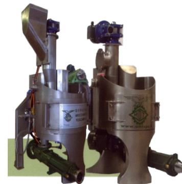
Se trata de un innovador sistema de prensado "Cuchillos Secuenciales". El eje de rotación de los órganos trituradores es vertical, sistema que garantiza un correcto prensado a 36 grados a través de los orificios de la parrilla, y ayuda a que la pasta salga de forma natural desde los orificios de la parrilla sin ningún tipo de estreñimiento, eliminando así el efecto de un posible calentamiento de la propia masa que se produce con otros sistemas de trituración. (ver uso con martillos)
