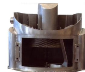
Detalle de la unidad rompedora y cámara de lavado continuo
